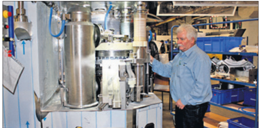
Montageleiter Harry Franke vor einem Highend-Produkt: die Hochleistungs-Doppelrundlaufpresse XT 600. Foto: at
