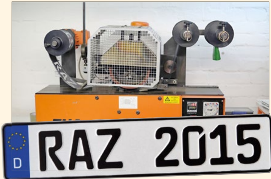
Die Schilder-Prägemaschine fertigt auch Wunschkennzeichen.
