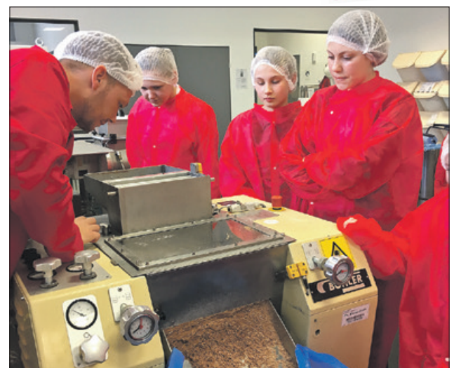
An dieser Maschine wird die Schokoladenmasse gewalzt. Foto: at
